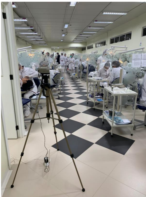
Figura 20: Sonômetro em medição no Ponto 3 da Clínica II
