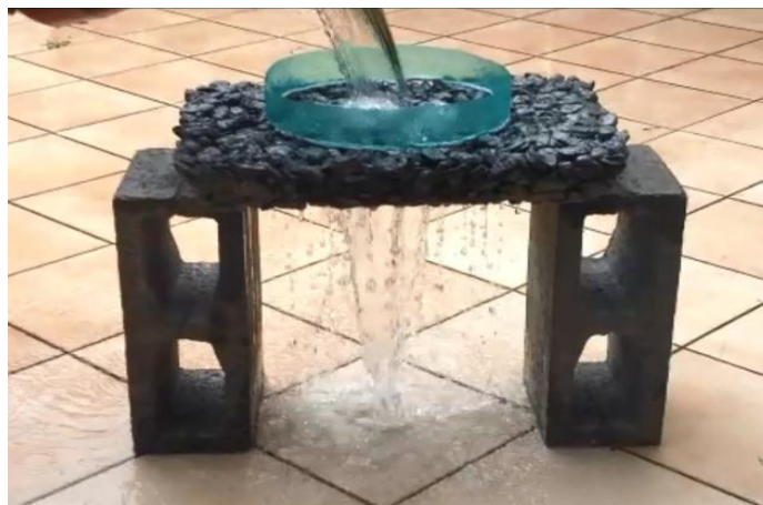
Figura 1 - Ensaio de permeabilidade no Traço C
