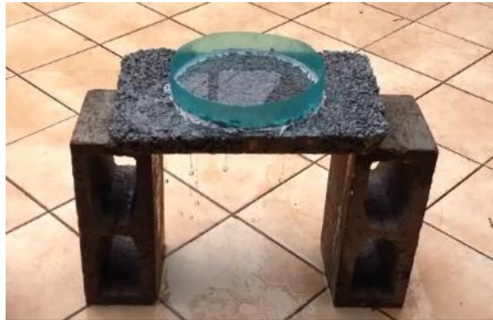
Figura 08 - Ensaio de permeabilidade no Traço A
