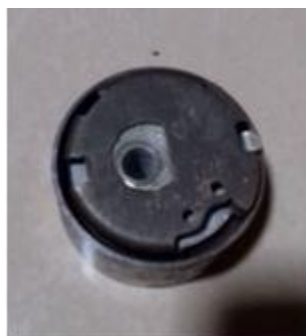
Figura 05: Peso utilizado para teste de impacto
