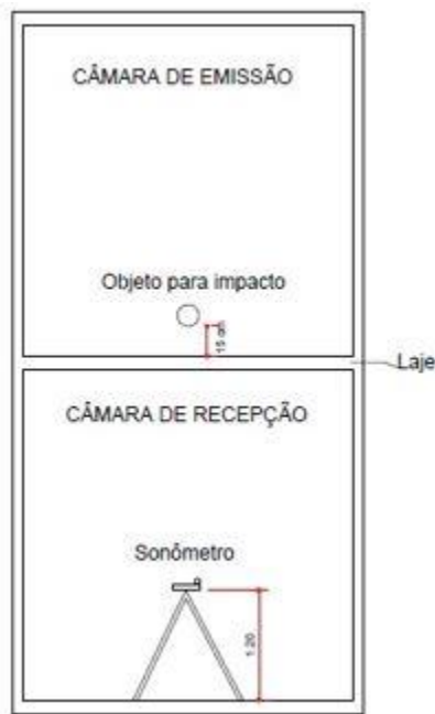
Figura 06: Esquema da sala de medição dos ruídos de impacto
