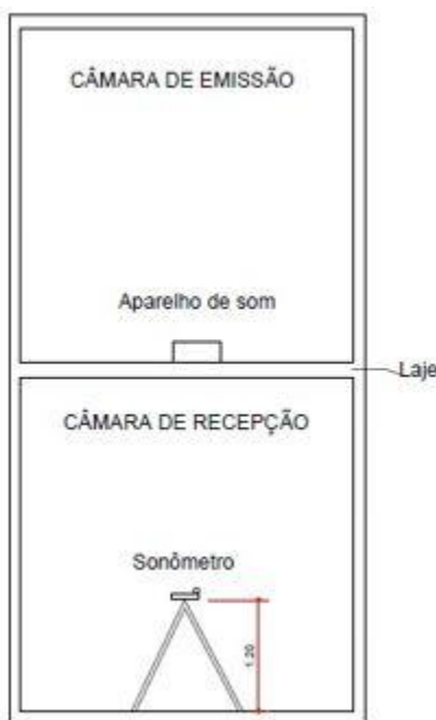
Figura 01: Esquema da sala de medição dos ruídos aéreos
